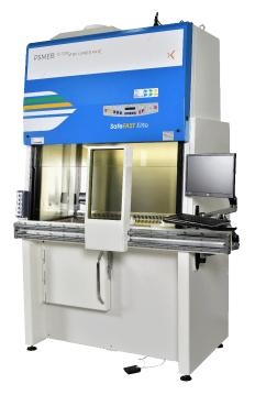
Der Strahlenschutz wird durch eine Bleiabschirmung verschiedener Dicken (5 - 25 mm) entsprechend des gewählten PSMEB-Modells gewährleistet. Damit für den Anwender ein homogener Ganzkörperschutz erreicht wird, der allen Manipulationen im kontrollierten Arbeitsbereich angepasst ist, hat die PSMEB Sicherheitswerkbank ein bewegliches Durchblickfenster aus 30 bis 80 mm dickem Bleiglas (Modellabhängig).
